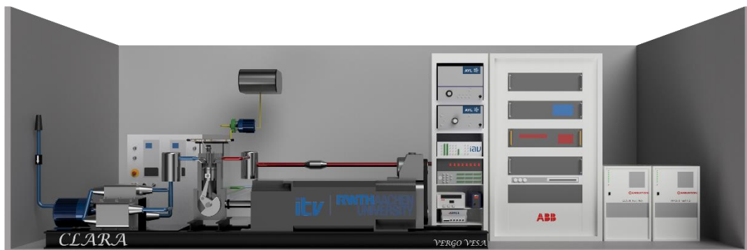
Abbildung 1 Schematische Darstellung des ITV Einzylinder Prüfstands
