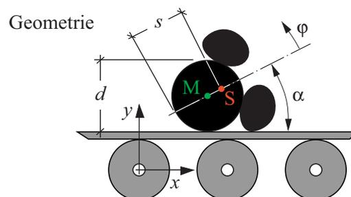
Ges.: Die Abrollbedingungen  $a_{S,x} = \text{fkt}_1(a_F, d, s, \alpha, \ddot{\varphi})$  und  $a_{S,y} = \text{fkt}_2(a_F, d, s, \alpha, \ddot{\varphi})$  für ein Anfahren aus dem Stillstand.
