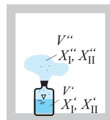
Fiktiver Zustand im Gleichgewicht **ohne** Mischung der ausgetretenen Gas-mischung mit der Luft
