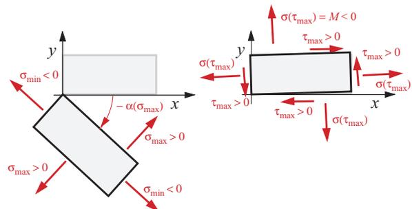
Bezüglich der Schubspannung bedeutet dies, dass die Richtungen 1 und 3 nahezu maximale Schubspannungen aufweisen.
