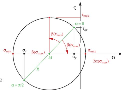
Die maximale und minimale Normalspannungen sowie die maximale Schubspannung sind:
