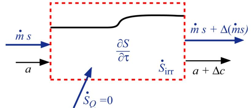
In Strömungsrichtung muss also die Temperatur konstant bleiben (verlustlose Strömung) oder zunehmen (verlustbehaftete Strömung).
