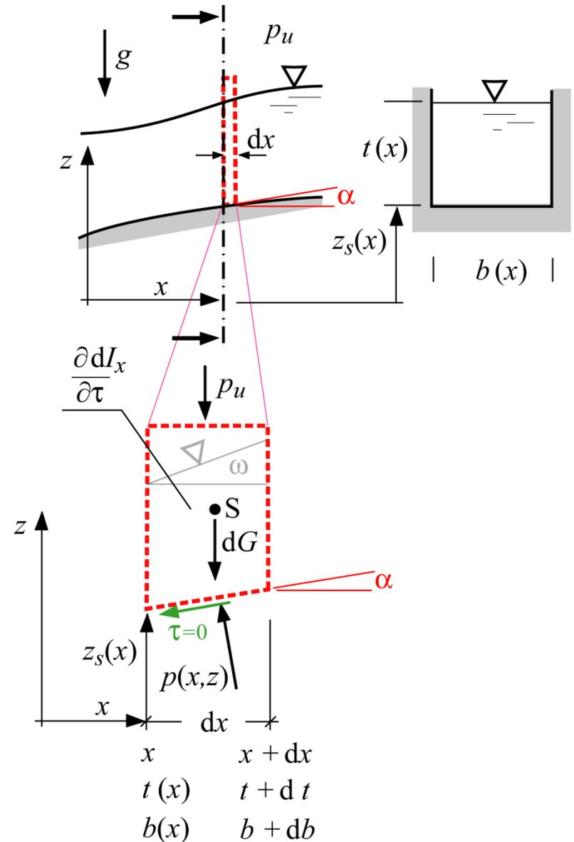
An den durchströmten Flächen können wir, da der Druck linear in  $z$ -Richtung abnimmt, jeweils mittlere Drücke einführen:
