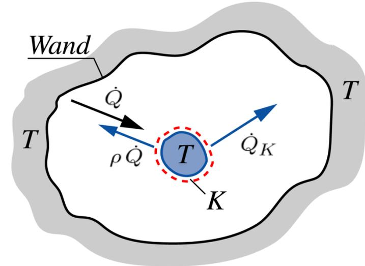
Der Körper selbst emittiert einen Energiestrom, dessen Betrag  $\dot{Q}_K$  durch den Stoff des Körpers und durch seine Temperatur festgelegt ist.
