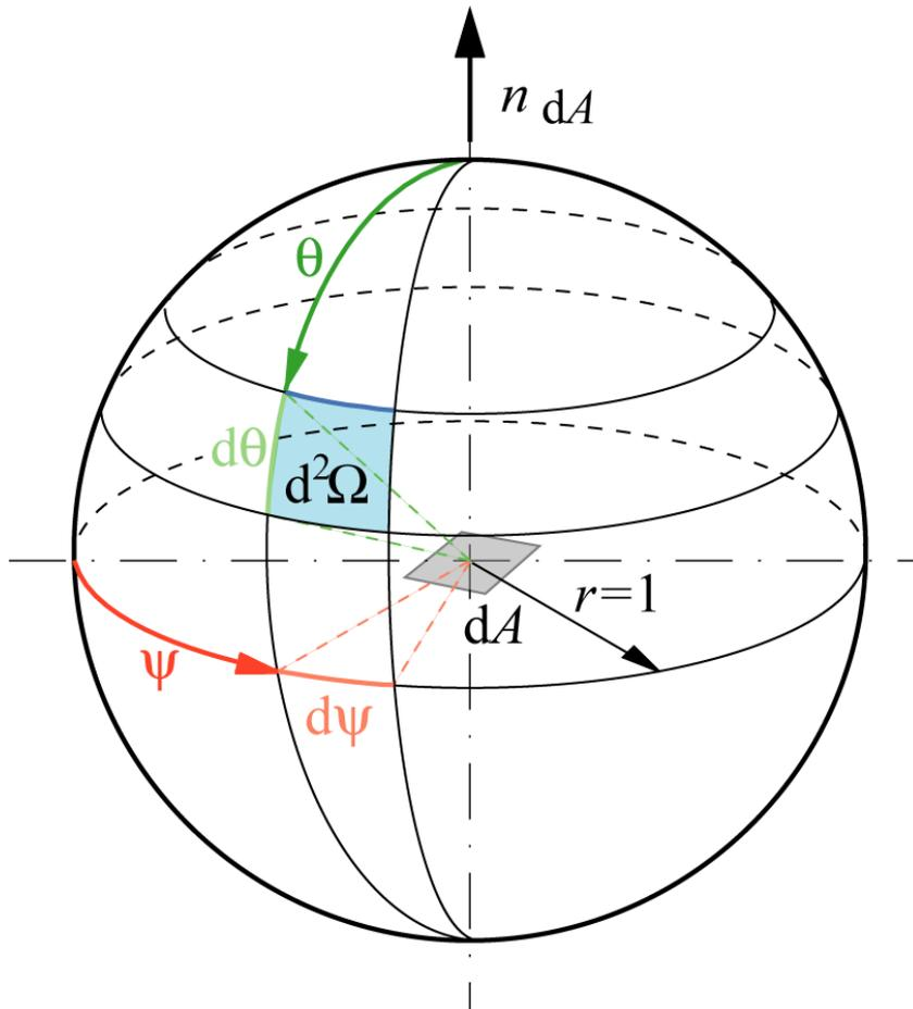
Zur Diskussion der Richtungsabhängigkeit der Strahlung ausgesandt von einem Flächenelement  $dA$ , legen wir um das Flächenelement eine Kugel mit dem Einheitsradius  $r = 1$ .
