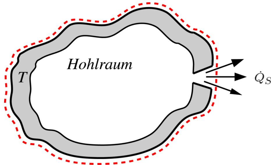
Je größer der Hohlraum und je kleiner die Öffnung, desto besser wird die Schwarzkörperstrahlung approximiert, die durch die genannten drei Bedingungen definiert ist.
