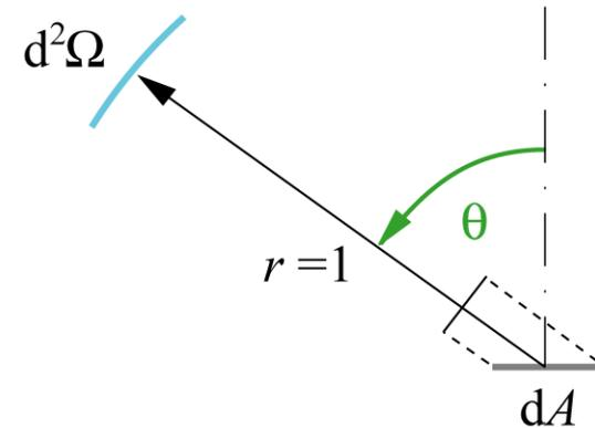
Die insgesamt in den oberen Halbraum HR je Flächen- und Zeiteinheit ausgestrahlte **Strahlungsflussdichte** ergibt sich aus Integration zu:
