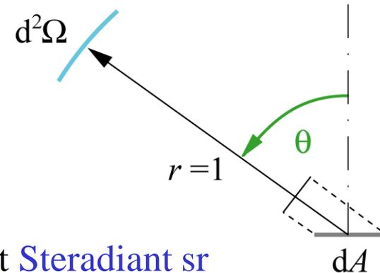
Die Gesamtheit aller dieser Strahlenkegel aus  $dA$  liefert den endlichen Beitrag an Strahlung durch den Raumwinkel. Diese Gesamtheit bildet ein **Strahlenbündel**.
