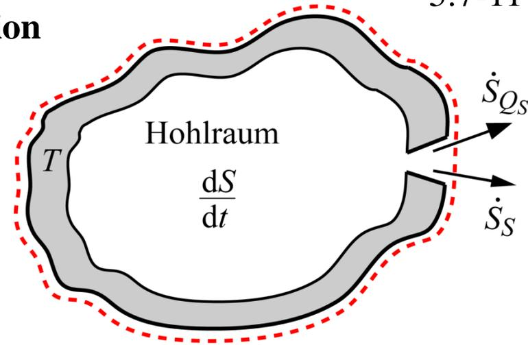
Dem Körper wird über die Oberflächenabstrahlung die Strahlungswärme entzogen, damit verbunden ist ein Entropieänderung:
