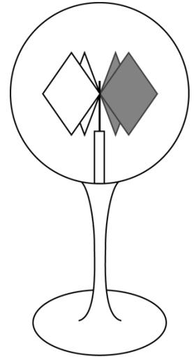
Beobachtet im Experiment: eine umgekehrte Drehrichtung ← **Radiometereffekt nach Crookes**
