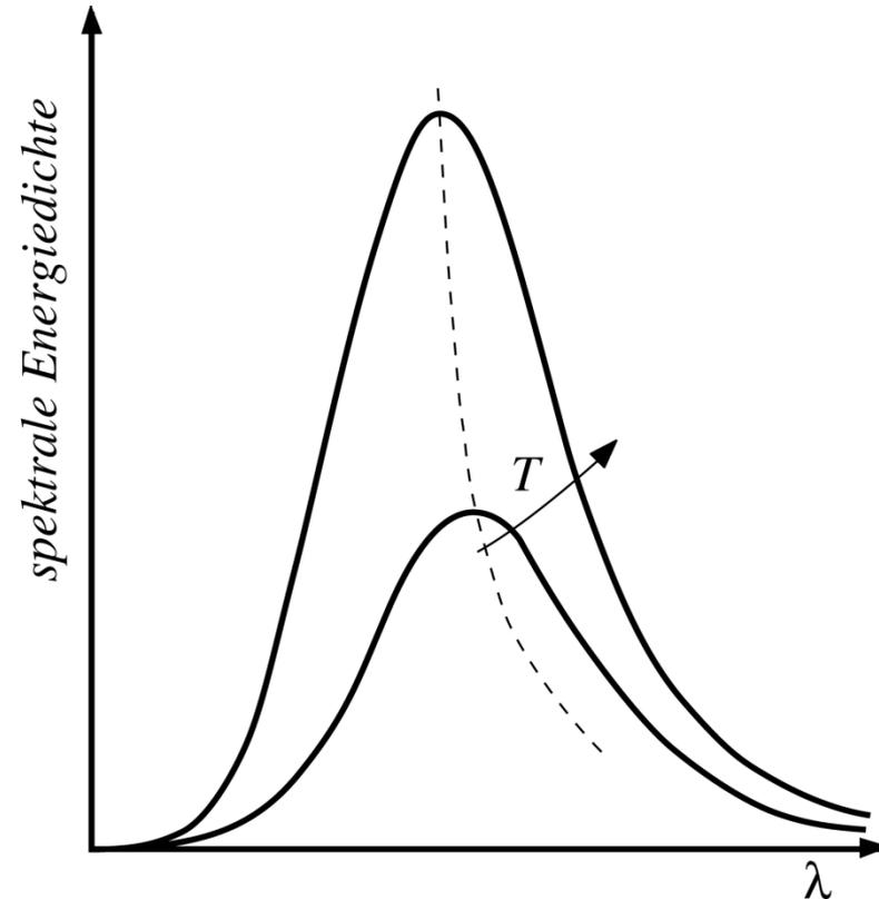
Für höhere Temperaturen steigt die abgestrahlte Energie für jede Wellenlänge.
