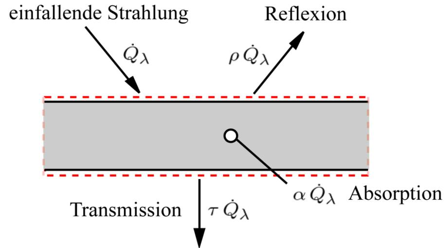
Der nichtreflektierte Teil der Strahlung wird vom Körper zu einem Teil absorbiert
